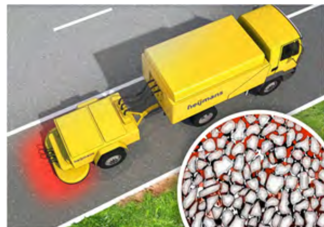
شکل ۴ شماتیکی از دستگاه گرمایش القایی در روسازی آسفالتی
